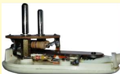
约 1972 年。在利摩日由 Jidé 制造的品牌为 Jidéstat 的电源控制箱。是所有系统中最成功的。尺寸非常小，它是可调节的，并且是合并到电插头里。这是唯一一款带一个速动磁铁触点的型号。直到现在的这个年代，它才被机电系统所超越。（Ultimheat 收集）。
