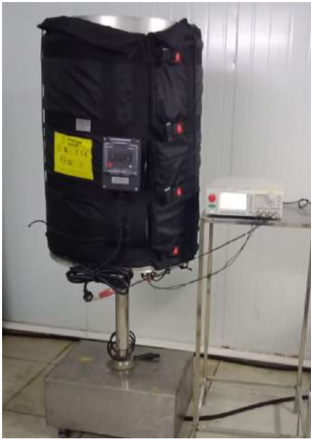
IPx6 测试后的绝缘电阻测量
