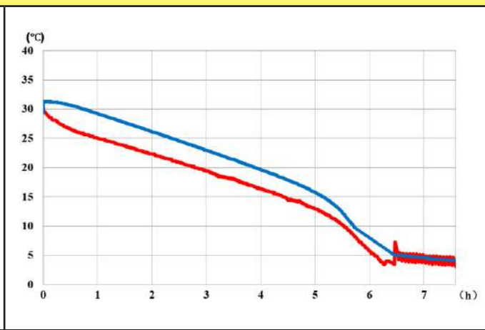
容器内的水温变化，当环境温度是 -35^{\circ}C 时，带有一个 0.1W/cm^2 ( 300W ) 的表面负载。 可以得出尽管加热功率增加，但罐的内部温度会继续缓慢下降。
