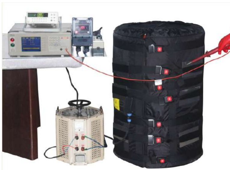
在热条件下总电流泄漏的测量设备
