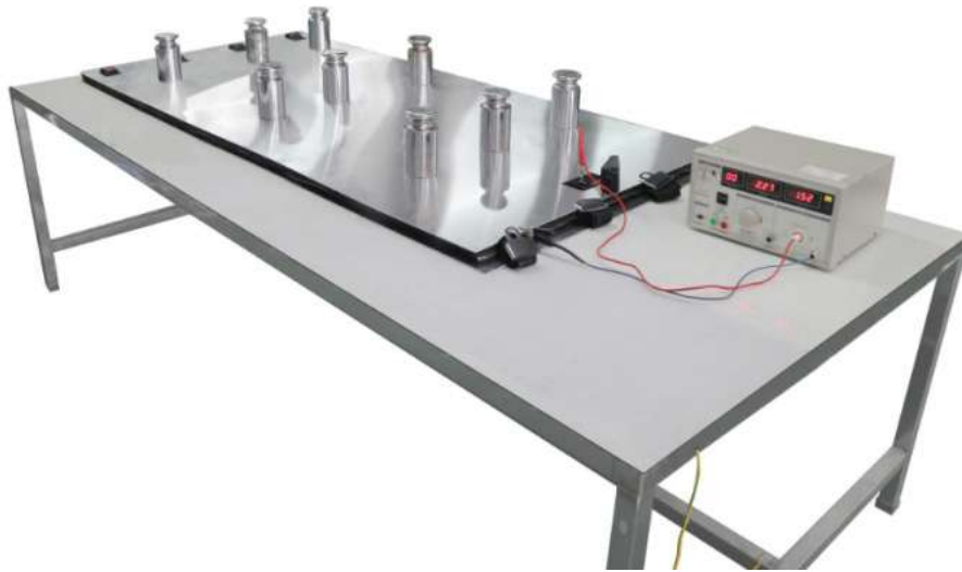
冷态下总电流泄漏的测量设备
