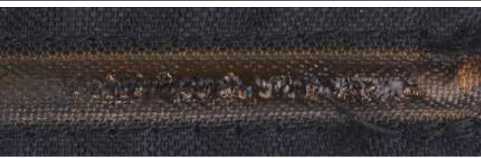
发热电缆在 235^{\circ}C 持续 1 小时：PA66 开始熔化
